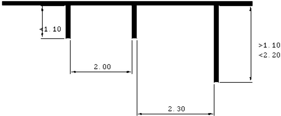
Figure 2 Détail du fond d'emplacement (stationnement à 90°)
